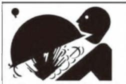
Visok pritisak peščanog filtera može prouzrokovati teške povrede ili veliku materijalnu štetu zbog odvajanja rezervoara.
