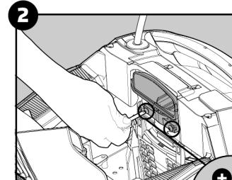
Abra los 2 tornillos con un destornillador corto.
