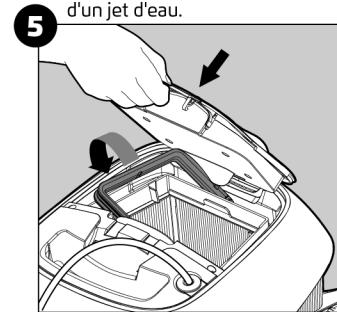
Réinsérez l'assemblage de filtrage nettoyé et fermez le couvercle.
