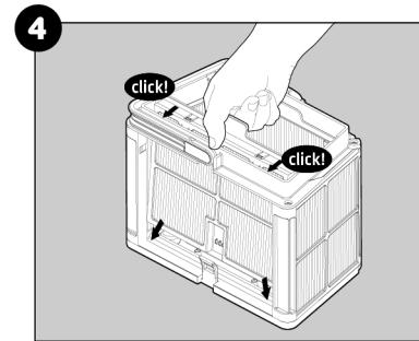
Réassemblez les panneaux de filtrage.
