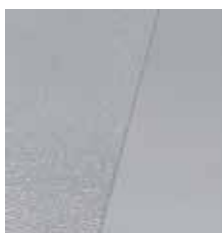
■ Mogućnost postizanja glatke ili protivklizne površine
